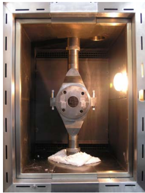
Fig. 7 복합재/알루미늄 링 시편의 극저온 시험장치[13]
